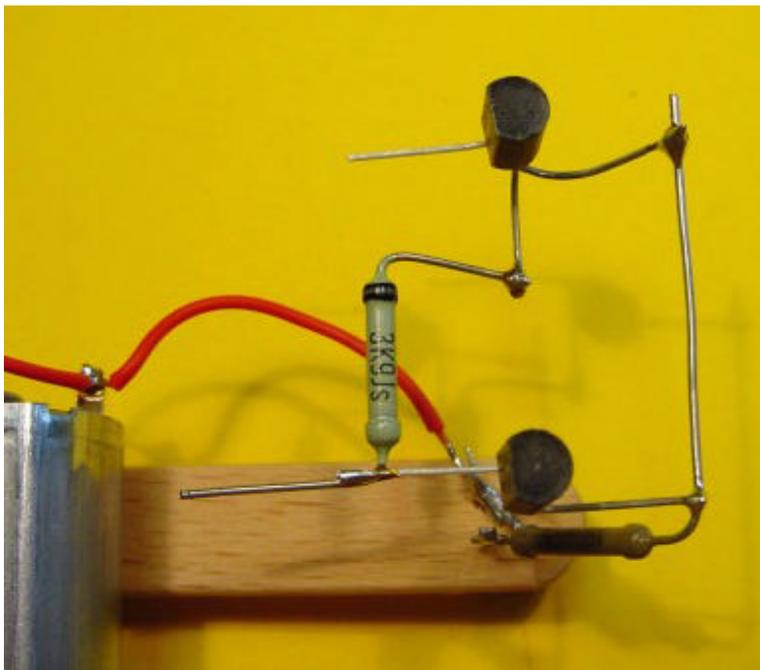
Nun ziehen wir noch von jedem Kollektor einen Schaltdraht zum Motor:
