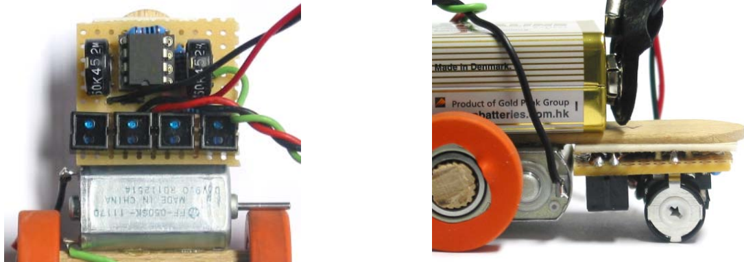
Abbildung 19: Verstärker mit vier Reflexkopplern auf einer Platine
